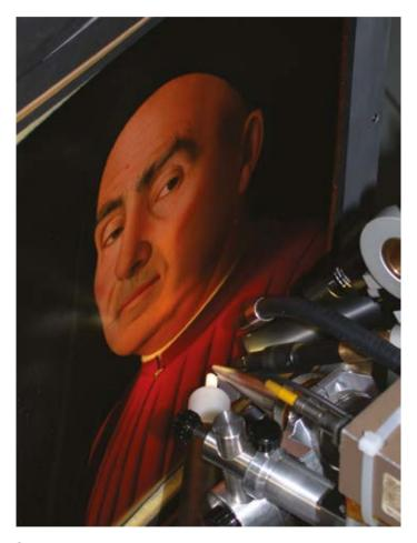
a. Analisi del dipinto "Ritratto d'uomo", di Antonello da Messina (1476), con la tecnica PIXE (Particle Induced X-ray Emission) nel laboratorio LABEC nel 2007. La PIXE ha permesso, senza alterare minimamente l'opera d'arte, di capire la composizione dei pigmenti, rivelando la tecnica pittorica utilizzata.
