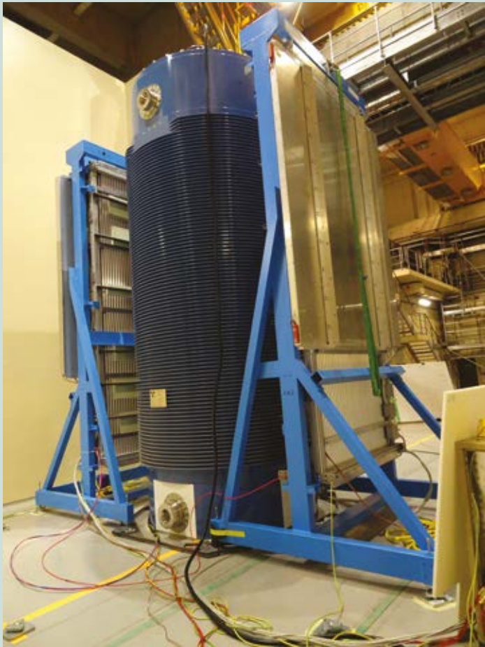
a. Un cask con a fianco i tracciatori di muoni costruiti dall'INFN (montati sui supporti blu). I muoni cosmici rivelati dai tracciatori attraversano anche il contenitore, permettendo di ispezionarne il contenuto.
