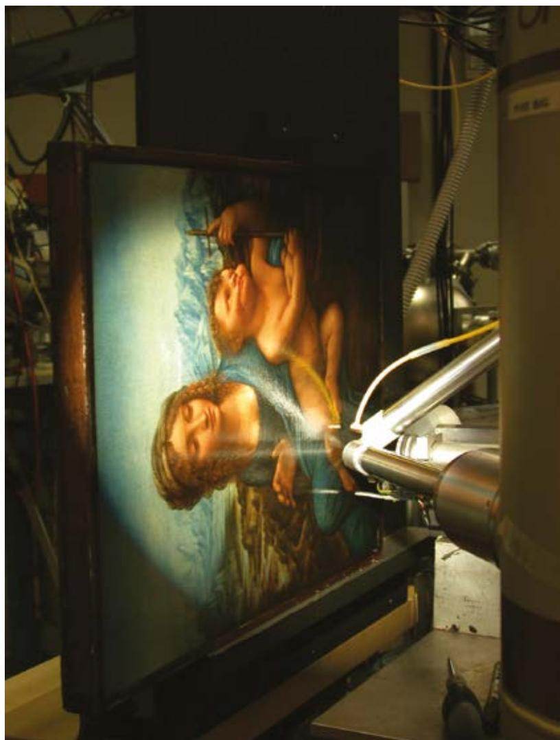
**c.** Un dipinto di Leonardo analizzato con un fascio di protoni estratto dal canale in vuoto dell’acceleratore di Firenze: si notano i rivelatori per raggi X e gamma utilizzati per le misure PIXE e PIGE, rispettivamente.
