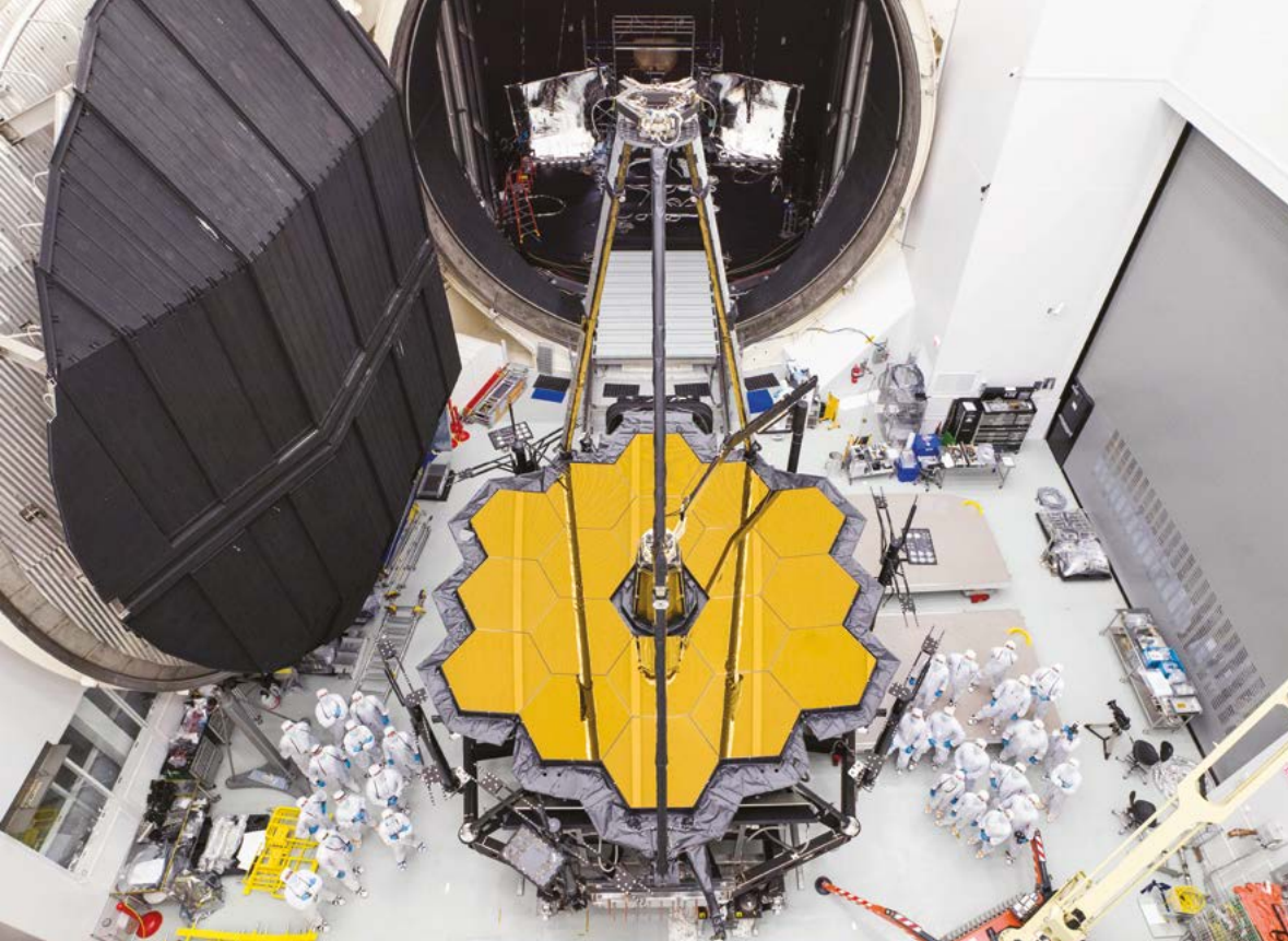
b. Il telescopio Webb al termine dei test eseguiti nei laboratori del Johnson Space Center della NASA in Texas, nel 2017. Sul retro, l'entrata e l'enorme porta del gigantesco criostato usato per ricreare le condizioni di vuoto e freddo dello spazio.
