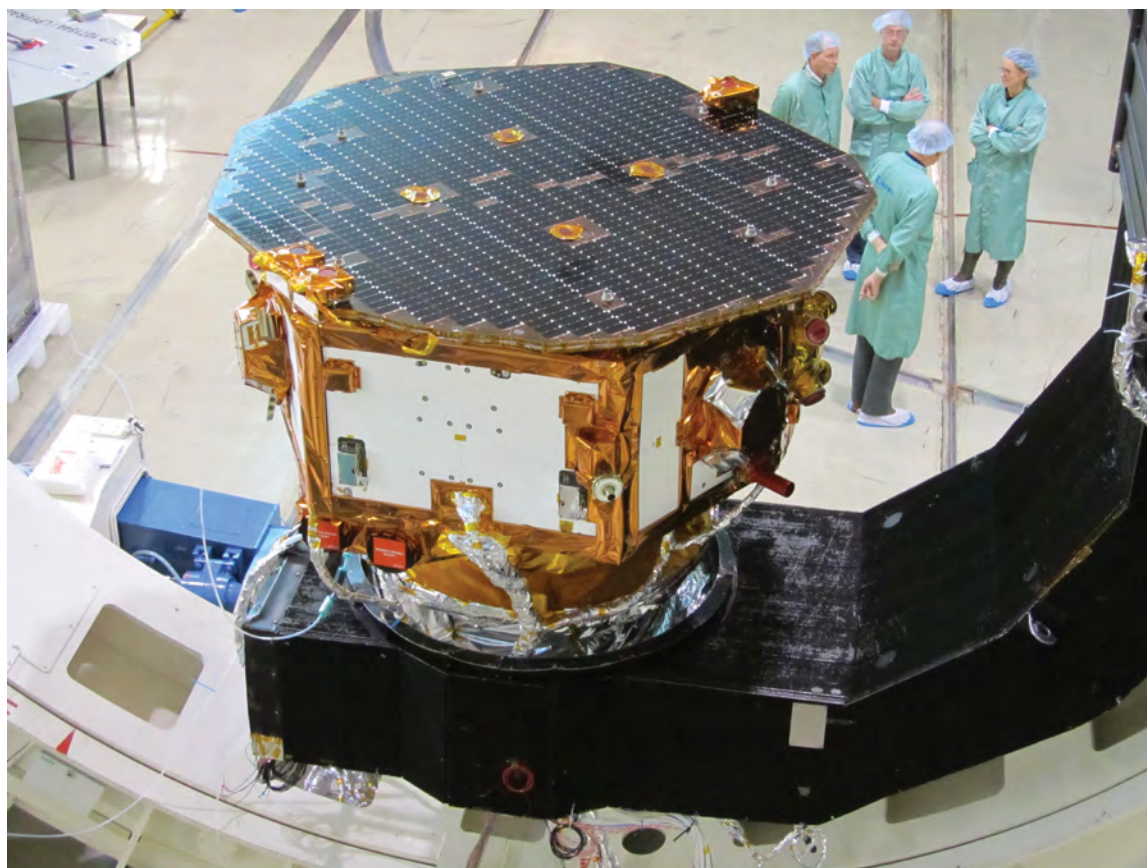
c. Il modulo Lisa Pathfinder nei laboratori di test a Ottobrunn, in Germania. Il successo della missione Lisa Pathfinder ha dimostrato la fattibilità delle tecnologie alla base dell'ambizioso progetto spaziale Lisa.
