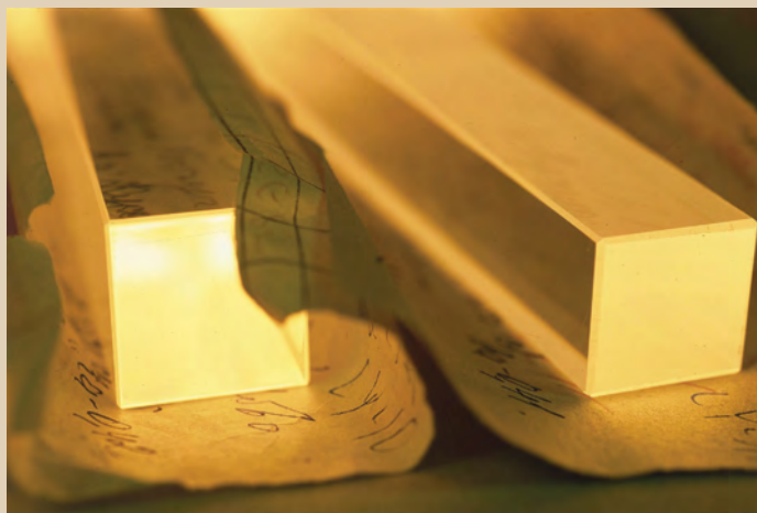
a. Cristalli scintillanti di tungstato di piombo utilizzati per il calorimetro elettromagnetico di Cms.
